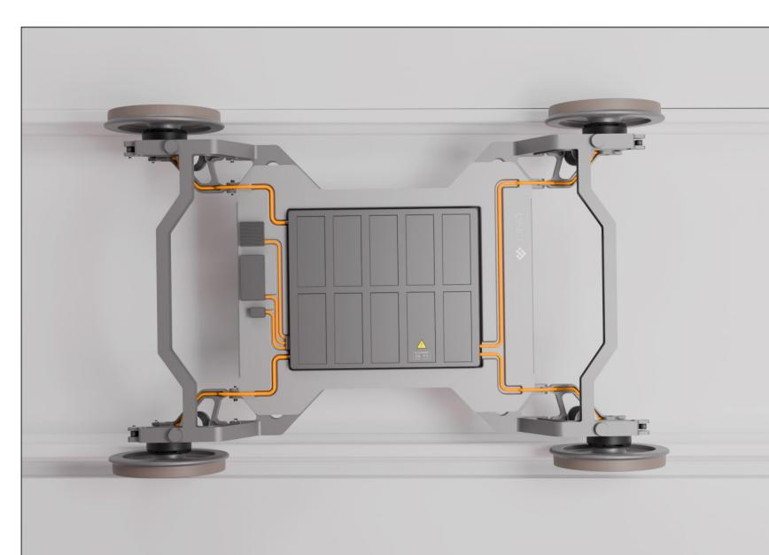
Das Fahrwerk ist die tragende und technische Basis des REAKT LINQ. Es vereint Antrieb, Federung, Energieaufnahme und Radführung und die vier Radnabenmotoren in einer kompakten Einheit und bildet die stabile Plattform für die gesamte darüberliegende Forschungsstruktur.
