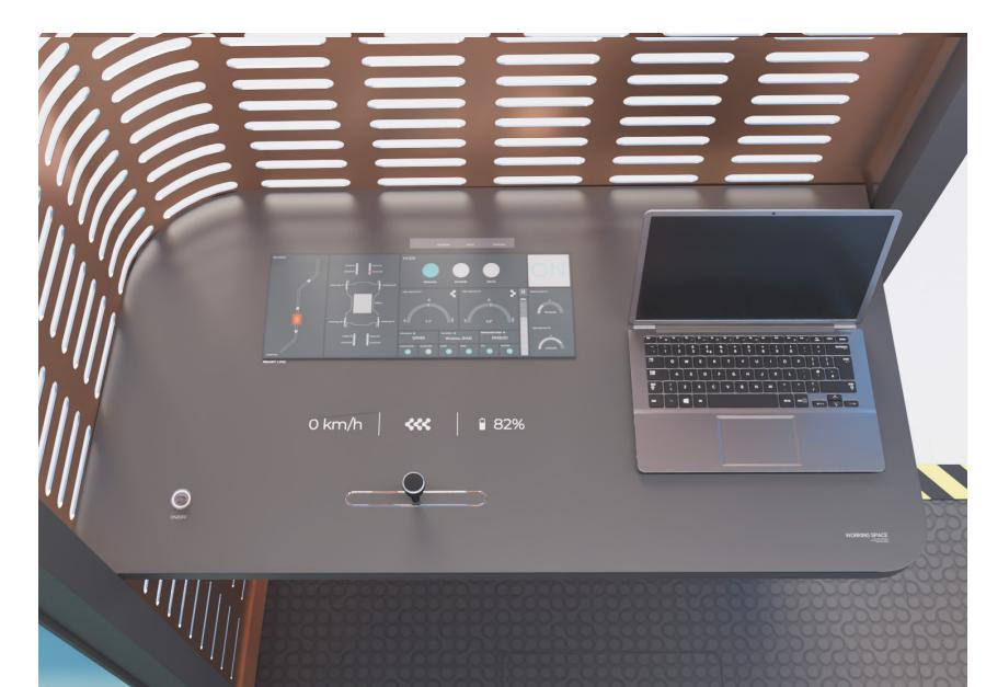
Die Steuereinheit ist kompakt in einer Ecke des Fahrzeugs angeordnet und zeigt die wichtigsten Elemente und Anzeigen beleuchtet an. Sie verfügt über einen Fahrhebel, einen integrierten Display mit Echtzeitdaten sowie ausreichend Platz, um einen Laptop anzuschließen.
