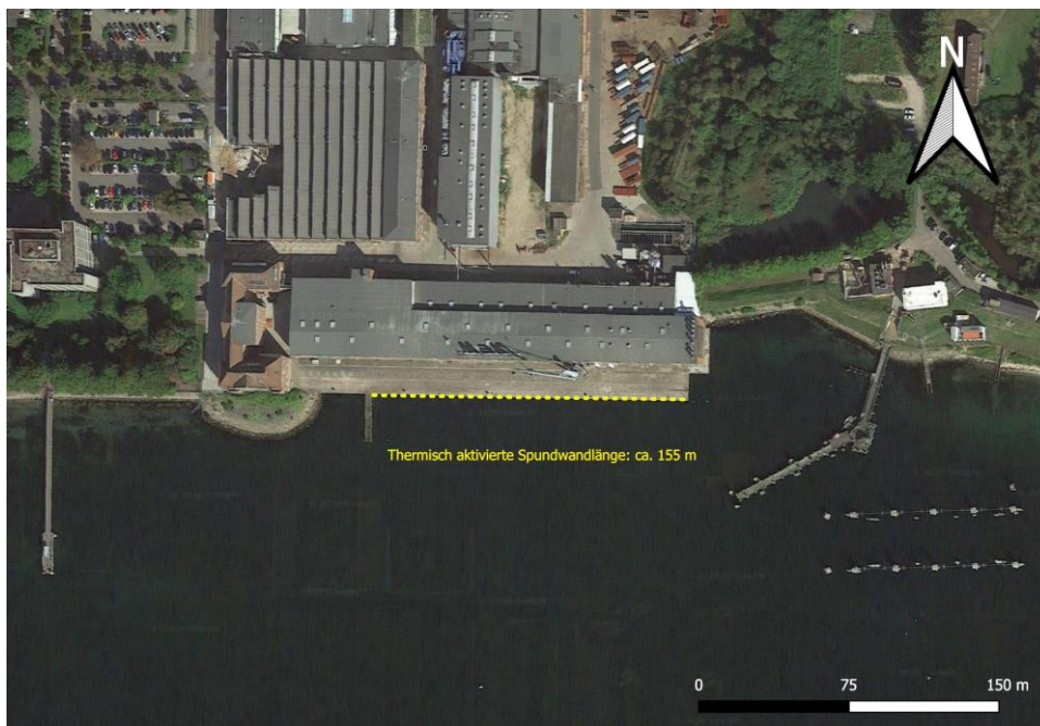
Abbildung 12: „Tiefer“ Teil der Spundwand mit einer Länge von ca. 155 m.
