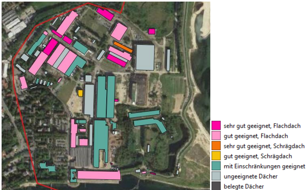
Abbildung 14: Abschätzung der Dacheignung für Solaranlagen
